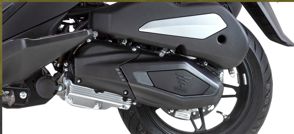
Motor monocilíndrico 244cc - 25hp - EFI - Refrigeración líquida
